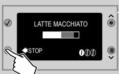
**8** Aparat ispušta kavu nakon što završi ispuštanje pjene od mlijeka. Pritisnite tipku "汲" kako biste prijevremeno prekinuli ispuštanje.
