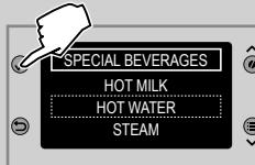
**3** Nakon što odaberete HOT WATER, pritisnite tipku za pomicanje "V" ili "A" te potvrdite unos pritiskom ".
