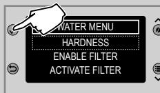
**7** Odaberite mogućnost HARDNESS pritiskom tipke "✓" i programirajte vrijednost tvrdoće vode.
