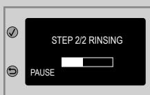
**13** Započinje izvođenje postupka ispiranja. Traka omogućava uvid u stanje napretka izvođenja postupka.
