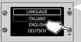
**13** Prikazuje se zaslon koji je prikazan sa strane. Odaberite željeni jezik pritiskom tipke za pomicanje "✓" ili "↖".
