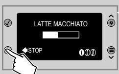
**7** Kada se prikaže zaslon koji je prikazan sa strane, aparat pokreće ispuštanje tučenog mlijeka. Pritisnite tipku "汲" kako biste prijevremeno prekinuli ispuštanje.
