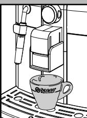
Za izvedbo nastavitev ročno dvignite ali znižajte pipo za točenje in jo s prsti postavite kot je prikazano na sliki.
