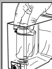
Filter vstavite v prazno posodo. Pritisnite dokler se ne ustavi.
