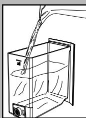
**Rezervoar dobro splaknite in napolnite s svežo pitno vodo do oznake nivoja MAX. Rezervoar vstavite v kavni aparat.**
