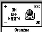
**i** **Opomba:** ko se mora filter "Intenza" zamenjati z novim, morate funkcijo ponastaviti. Filter zamenjajte kot je bilo prej prikazano. Nato vstopite v meni programiranja do prikazanega okna in izberite opcijo "RESET"; nato pritisnite tipko " ". S tem je aparat programiran za upravljanje novega filtra.
