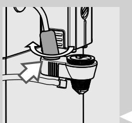
**28** Verifique se está correctamente posicionado. Se não o conseguir inserir, deverá rodar a cobertura cromada. O Batedor de leite automático está montado correctamente quando o dente se introduz na estria.
