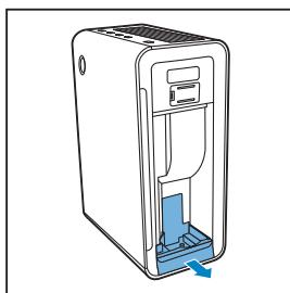
6 將加濕過濾網放回加濕過濾網盤。
