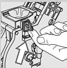
**13** 確保鎖定沖煮系統的鎖鉤處於正確位置。如果仍處在下壓位置，請往上壓入直到卡入定位。
