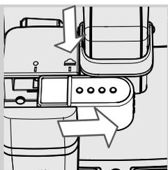
3 將鮮奶壺釋水管向右拔出至「☕」圖示。
