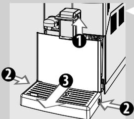
**17** 若要清潔滴水盤，放入「咖啡油脂清潔劑」並加熱水到 2/3 高度。等待約 30 分鐘，讓溶劑發揮功效，接著再徹底沖洗。
