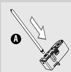
**14** 插入吸管，然後將連接管 (A) 插入泡器。
