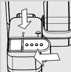
**16** 將鮮奶壺釋水管放回原位，向上滑動至「●」圖示處。取下並清空鮮奶壺。
