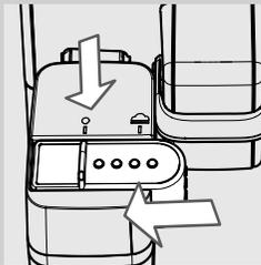
**13** 將鮮奶壺釋水管放回原位，向上滑動至「●」圖示處。
