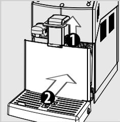
**4** 將咖啡粉槽插回滴水盤中，再將滴水盤放入咖啡機中。
