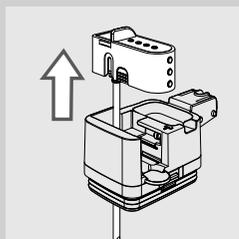
3 拉起咖啡龍頭，將其從鮮奶壺頂部取下。鮮奶壺釋水管由六個必須可拆卸的零件組成。每個零件均用大寫字母標識（A、B、C、D、E、F），如下圖所示。
