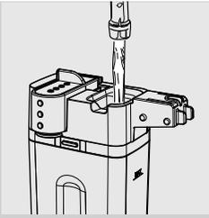
**4** 取下頂蓋，向鮮奶壺中注入乾淨的水，直到 MAX（最大）刻度。
