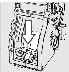
**11** 輕輕拉下控制桿，直到它接觸沖煮系統底座，與兩個在沖煮系統旁的參考標誌匹配為止。
