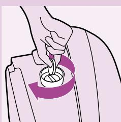
**8** 用特制的钥匙或硬币将水垢清洗塞装回蒸发水箱并且拧紧。
