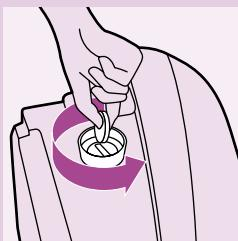
**4** 将蒸发水箱转向侧面，用特制的钥匙或硬币拆下水垢清洗钮和水垢清洗塞。
