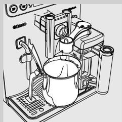
**15** Vuotare il contenitore e riposizionarlo sotto l'erogatore caffè. Aprire l'erogatore del latte ruotandolo in senso orario.
