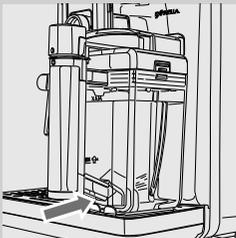
**9** Posizionare un contenitore capiente (1,5 l) sotto l'erogatore. Aprire l'erogatore del latte ruotandolo in senso orario.
