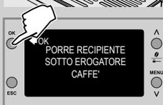
**6** Posizionare un contenitore (1,5 l) sotto l'erogatore del caffè. Premere il tasto "OK" per avviare il ciclo di pulizia.
