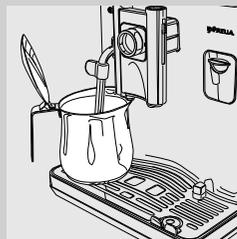
**1** Posizionare un contenitore sotto il tubo vapore/acqua calda.
