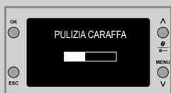
**11** Viene visualizzato il simbolo a lato. La barra consente di visualizzare lo stato di avanzamento del ciclo.
