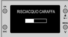
**16** La macchina inizia a erogare acqua sia dall'erogatore caffè che dall'erogatore del latte. La barra consente di visualizzare lo stato di avanzamento del ciclo.
