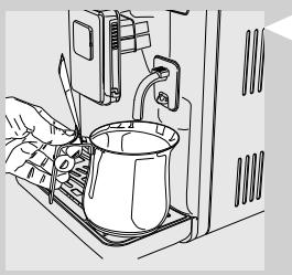
**6** Τοποθετήστε ένα μεγάλο δοχείο (1,5 l) κάτω από ακροφύσιο νερού.
