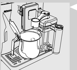
**9** Τοποθετήστε ένα μεγάλο δοχείο (1,5 l) κάτω από το ακροφύσιο. Ανοίξτε το ακροφύσιο γάλακτος γυρνώντας το δεξιά.
