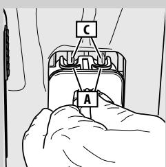
Σε αυτή τη φάση, οι οπές του ακροφυσίου (A) βρίσκονται πιο χαμηλά από τα σημεία σύνδεσης (C). Οι πείροι του ακροφυσίου βρίσκονται στο ίδιο ύψος με τους οδηγούς.
