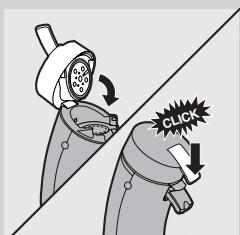
**7 Zamknij pokrywkę i zablokuj dźwignię.**
