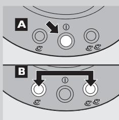
**9** Нажмите кнопку включения / выключения  $\textcircled{1}$  and , затем одновременно нажмите кнопки приготовления 1 чашки Ⓛ и 2-х чашек Ⓛ Ⓛ .
