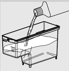
**6** Extraer el depósito de agua y verter en él todo el contenido de la solución descalcificante. A continuación, rellenar el depósito con agua fresca hasta el nivel CALC CLEAN.
