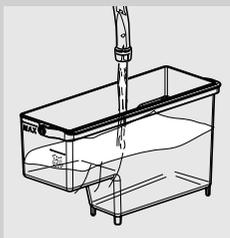
**12** Extraer el depósito de agua, enjuagarlo y llenarlo con agua fresca hasta el nivel MAX. Volver a introducirlo en la máquina. Al introducir el depósito de agua en la máquina, se visualiza la siguiente pantalla.
