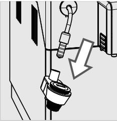
**2** Sacar el Montador de leche Automático del tubo de vapor/agua caliente.
