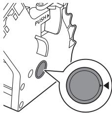
1 将冲煮组件推回咖啡机之前，确保侧面的两个黄色参考标记相匹配。如果不匹配，请执行以下步骤：
