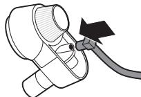
2 将自动奶泡器上的橡胶胶套插入热水/蒸汽出水口，直至锁定到位。
