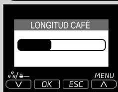
Ajustando la barra de la pantalla por medio de los botones de desplazamiento "V" o "Λ", es posible seleccionar la cantidad de agua utilizada para el suministro de café.
