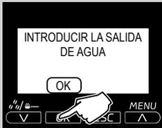
**13** La máquina indica que se instale la salida de agua. Asegurarse de que esté correctamente posicionada. Pulsar "OK" para confirmar.
