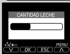
Ajustando la barra de la pantalla por medio de los botones de desplazamiento "V" o "Λ", es posible seleccionar la cantidad de leche utilizada para la bebida seleccionada.
