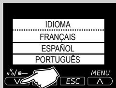
**13** Se muestra la siguiente pantalla. Seleccionar el idioma deseado pulsando los botones de desplazamiento "V" o "^".
