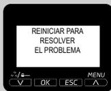
Tomar nota del código (E xx) mostrado en la parte inferior de la pantalla. Apagar la máquina. Volver a encenderla tras 30 segundos. Repetir el procedimiento 2 o 3 veces.
