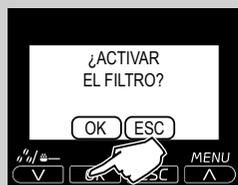
**11** Pulsar el botón "OK" para confirmar que se desea realizar el procedimiento de activación del filtro.
