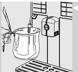
**9** Nakon što ste ispustili vodu, uklonite i ispraznite rezervoar.
