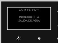
**6** Se mostrará el símbolo adyacente. La máquina indica que se instale la salida de agua. Comprobar que la salida de agua esté correctamente instalada. Pulsar "✓" para confirmar. La máquina comenzará a suministrar agua caliente.
