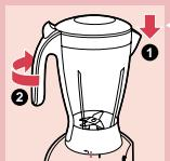
**2** Anbring blenderglasset på den øverste del af motorenhenen og drej det i pilens retning, til det sidder godt fast. Håndtaget skal pege til venstre.
