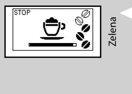
**9** Nakon završetka ispuštanja emulzioniranog mlijeka, aparat ispušta kavu. Za prekid ispuštanja, pritisnite tipku "MEMO".
