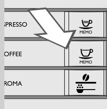
**6** Pritisnite tipku "CUP". Na zaslonu se prikazuje simbol prikazan sa strane.
