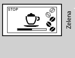
**8** Kada se pojavi simbol prikazan sa strane, aparat ispušta mlijeko. Za prekid ispuštanja, pritisnite tipku "MEMO".
