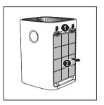
**4** 将无包装的空气净化滤网放回产品内。
