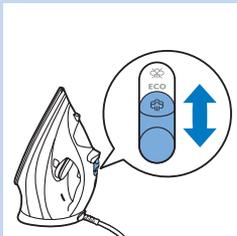
**3** Wählen Sie die Dampfeinstellung mit dem Dampfschieberegler aus.
