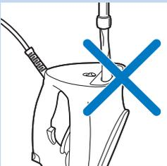
Gießen Sie weder Wasser, Essig, Entkalkungsmittel noch andere Chemikalien in die Quick Calc Release-Öffnung.
