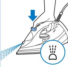
Sie können die Sprühfunktion bei jeder beliebigen Temperatur verwenden, um die Kleidungsstücke anzufeuchten. Dadurch lassen sich hartnäckige Falten besser entfernen.
