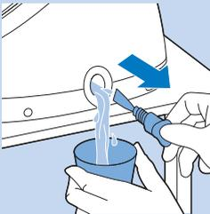
**6** Tháo nút EASY DE-CALC và để nước cùng với chất cặn chảy vào cốc.
