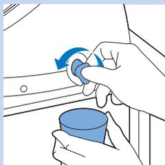
**5** 在 EASY DE-CALC (轻松除水垢) 旋钮下方握住一个杯子，然后逆时针旋转旋钮。
