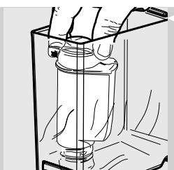
**4** Τοποθετήστε το φίλτρο στο άδειο δοχείο νερού. Σπρώξτε το στο χαμηλότερο δυνατόν σημείο.
