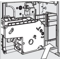
**16** Поставьте блок приготовления кофе на место, установив его на направляющие, чтобы он вошел в зацепление.
