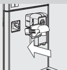
**1** Достаньте графин для молока, если он установлен. Слегка наклоните устройство подачи воды и полностью вставьте его в направляющие машины.
