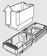
**3** Опорожните поддон для сбора отходов и промойте его свежей водой.
