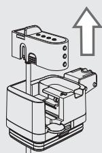
**4** Снимите всасывающую трубку со штуцером (A) со вспенивателя молока.
