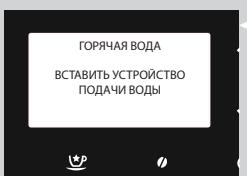
**6** На дисплее отобразится символ, показанный сбоку. Машина укажет на необходимость установки устройства подачи воды. Убедитесь, что устройство подачи воды установлено правильно. Нажмите «» для подтверждения. Машина начнет подачу горячей воды.
