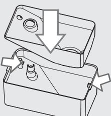
**6** После чистки и сушки, вставьте лоток обратно в емкость для кофе в зернах. Вставьте фиксаторы лотка в специальные гнезда емкости.
