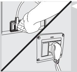
**11** Вставьте штепсельную вилку в розетку, расположенную в задней части машины.
