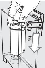
**11** Вставьте фильтр для воды «INTENZA +» в пустой бак для воды. Сдвиньте его как можно ниже.
