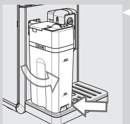
**1** Поверните графин вверх до его естественного отсоединения от вставки, расположенной в поддоне для сбора капель. Затем снимите его.
