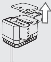
**3** Поднимите устройство подачи графина, чтобы вынуть его из верхней части графина.
