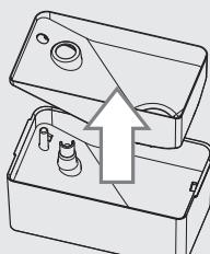
**5** Снимите лоток. Протрите лоток и емкость влажной тряпкой.
