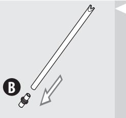
**5** Снимите штуцер (B) со всасывающей трубки.
