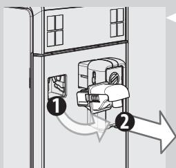
**1** Если установлено устройство подачи воды, снимите его, как показано на рисунке:
