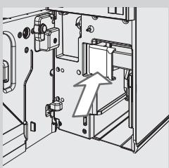
**17** Закройте рычаг блокировки блока приготовления кофе и заблокируйте блок.
