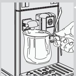
**3** Вставьте емкость под устройство подачи горячей воды.
