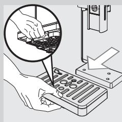
**7** Нажмите рычаг на нижней части и достаньте поддон для сбора капель (внешний); опустошите и помойте его.
