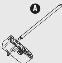
**5** Хорошо промойте свежей водой трубку со штуцером.
