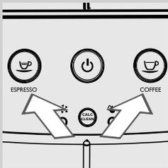
**15** La macchina esegue il riscaldamento ed il risciacquo automatico. Il tasto "☕" ed il tasto "☕" lampeggiano contemporaneamente. Il ciclo di decalcificazione è completo.
