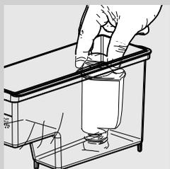
**18** Rimuovere il filtrino bianco e riposizionare il filtro acqua "INTENZA+" (se presente) nel serbatoio dell'acqua; risciacquarlo e riempirlo con acqua fresca fino al livello MAX. Reinserrarlo nella macchina.
