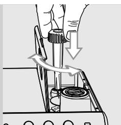
**2** Mentre la macchina macina, premere e ruotare la manopola di regolazione della macinatura posta all'interno del contenitore caffè in grani di uno scatto alla volta. Servirsi dell'apposita chiave di regolazione macinacaffè fornita in dotazione. La differenza di gusto sarà percepibile dopo aver erogato 2-3 caffè.
