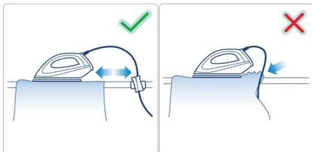
O CordGuide fixa o cabo num determinado local da tábua de modo a que não arraste acidentalmente e provoque vincos nas peças de roupa já engomadas.
