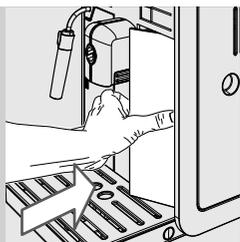
**1** Svakog dana, sa uključenim aparatom, ispraznite i očistite posudu za sakupljanje taloga.
