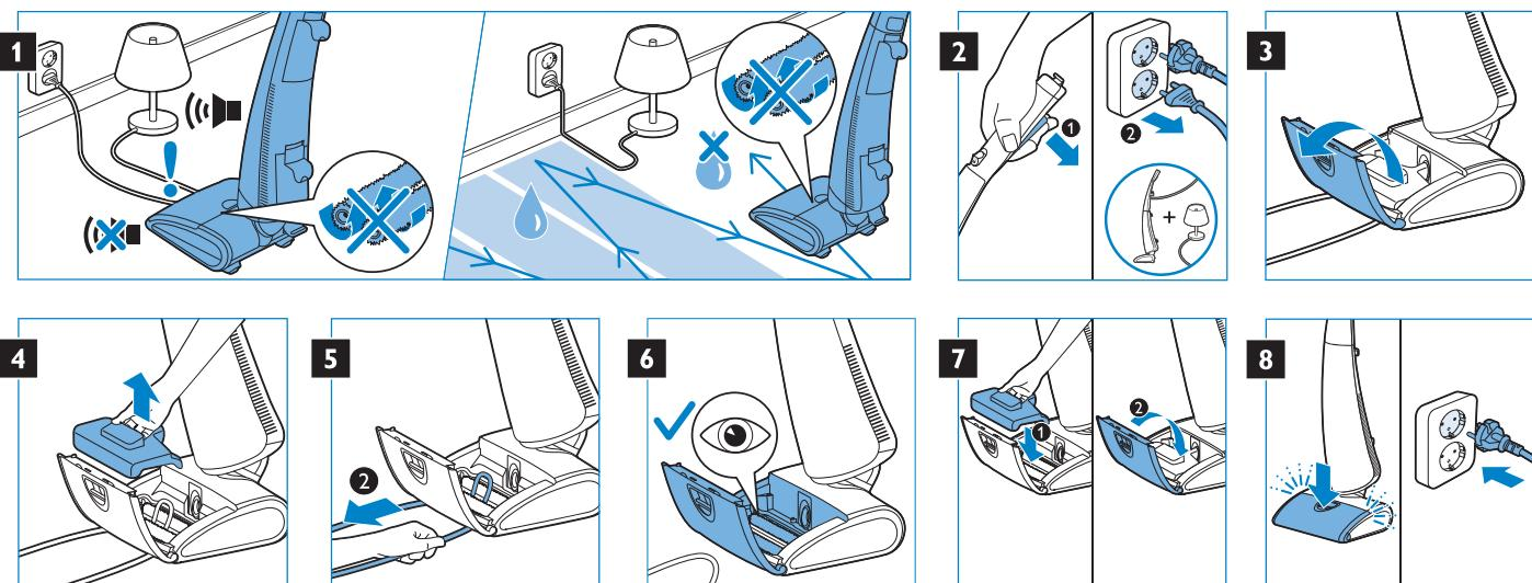
**Filling the clean water tank, Frischwasserbehälter füllen, Remplissage du réservoir d'eau propre,
