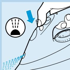
Voor het verwijderen van hardnekkige kreuken op elke temperatuur. Controleer of er genoeg water in het waterreservoir zit.
