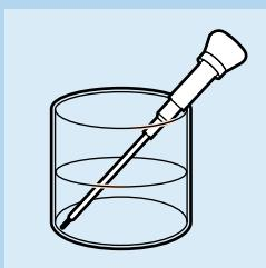
**8** Sollevate ancora un po' il regolatore di vapore per togliere l'astina. Usare l'aceto per eliminare l'eventuale calcare depositatosi sull'astina.
