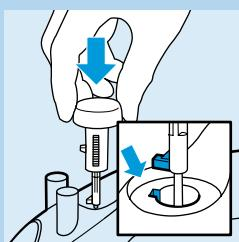
**9** Rimettete a posto l'astina inserendo la punta esattamente al centro del foro e agganciando nella cavità la piccola sporgenza posta sul lato dell'astina. Mettete la manopola del regolatore di vapore in posizione O.
