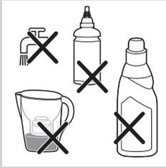
Let op: Gebruik **geen** kraanwater, geperfumeerd water, gekookt water, water uit een droger of luchtontvochtiger, regenwater, azijn, mineraalwater, magnetisch behandeld water (Aqua+), water uit een drinkwaterfilter, stijfsel, ontkalkers, strijkconcentraat, zout of chemicaliën in het waterreservoir. Deze soorten water zijn getest, zijn niet geschikt voor het apparaat en kunnen zelfs schade aan het apparaat veroorzaken. Als u deze soorten water gebruikt, vervalt uw garantie.
