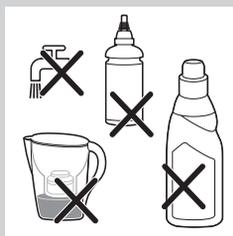
**Attention : N'utilisez pas** d'eau du robinet, d'eau parfumée, d'eau bouillie, d'eau provenant d'un sèche-linge, d'eau de pluie, de vinaigre, d'eau minérale, d'eau magnétique (Aqua+), d'eau filtrée, d'amidon, d'agents de détartrage, de produits de repassage, de sel ou d'autres produits chimiques dans le réservoir d'eau. Ces liquides ont été testés. Ils ne sont pas adaptés au fer et risquent même de l'endommager. Votre garantie s'annule si vous utilisez l'un de ces produits.
