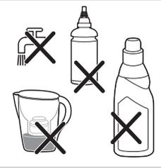
**Attenzione: non riempite il serbatoio con acqua di rubinetto, profumi, acqua bollita o proveniente da asciugatrici, acqua piovana, aceto, acqua minerale, acqua trattata magneticamente (Aqua+), acqua proveniente da un filtro per acqua potabile, amido, agenti disincrostanti, prodotti per la stiratura, sale o prodotti chimici. Questi tipi di acqua sono stati testati, risultando non adatti per l'apparecchio e spesso causa di danni. Se utilizzate questi tipi di acqua, la garanzia decade.**
