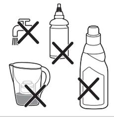
**Achtung: Verwenden Sie kein Leitungswasser, parfümiertes Wasser, abgekochtes Wasser, Wasser aus einem Wäschetrockner, Regenwasser, Essig, Mineralwasser, magnetisch behandeltes Wasser (Aqua+), Wasser aus einem Trinkwasserfilter, Stärke, Entkalker, Bügelhilfen, Salz oder Chemikalien im Wasserbehälter. Diese Arten von Wasser wurden überprüft. Sie sind nicht geeignet und können sogar Schäden am Gerät verursachen. Wenn Sie eine dieser Wasserarten verwenden, erlischt Ihre Garantie.**
