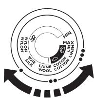
**3** Қажетті үтіктеу температурасын орнату үшін, температура дәңгелегін тиісті қүйге келтіріңіз (жоғарыдағы «Температура және бу параметрлері» кестесін қараңыз).
