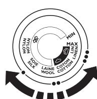
**3 Otočením regulátora do príslušnej polohy nastavte požadovanú teplotu pri žehlení (pozrite si vyššie uvedenú tabuľku „Nastavenia teploty a naparovania“).**
