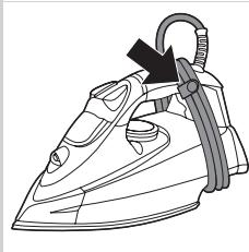
**1** Sietový kábel omotajte okolo výstupku na jeho odkladanie a zaistite ho svorkou na prichytenie kábla.
