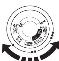
**3** Pentru a seta temperatura de călcare adecvată, reglați selectorul de temperatură pe poziția potrivită. (consultați tabelul de mai sus 'Setări pentru temperatură și abur').
