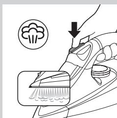
Усиливането на парата от гладещата повърхност с връх за пара помага за отстраняване на упорити гънки. То подобрява разпръскването на парата към всички части на дрехата.
