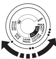
**3** Állítsa be a kívánt vasalási hőfokot a hőfokszabályzó tárcsa megfelelő helyzetbe fordításával (lásd a fenti „Hőfok- és gőzbeállítások” című táblázatot).
