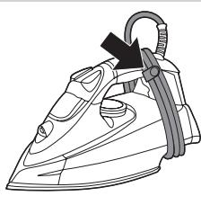
**1** Înfașurați cablul de alimentare în jurul suportului de depozitare a cablului și fixați-l cu clema.
