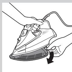
**1** Tylko wybrane modele: Zdejmij osłonę zabezpieczającą, odporną na wysokie temperatury.
