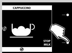
**7** Kada se prikaže ekran prikazan sa strane, aparat pokreće ispuštanje pjene od mlijeka. Za raniji prekid ispuštanja pritisnite tipku "**STOP MILK**".
