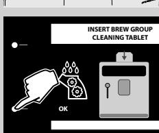
5 Ubacite jednu tabletu za odmašćivanje u odjeljak za prethodno samljenu kavu. Pritisnite tipku "OK".
