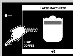
**9** Uklonite veliku šalicu i zatvorite ispušt mlijeka zakrećući ga u suprotnom smjeru od kazaljke na satu.
