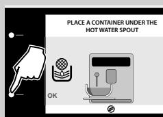
**13** Pritisnite tipku "OK" za potvrdu da se ispod ispusta vode nalazi spremnik.
