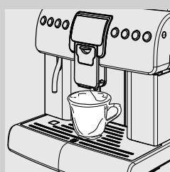
**1** Pod pipo za točenje postavite dovolj veliko posodo.
