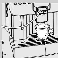
**7** Pod pipo za točenje postavite posodo.
