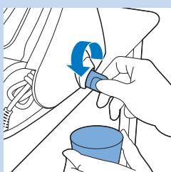
**5** Placez une tasse sous le bouton EASY DE-CALC et tournez-le dans le sens inverse des aiguilles d'une montre.
