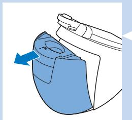
**2** Riempite il serbatoio con acqua del rubinetto fino al livello massimo (MAX).
