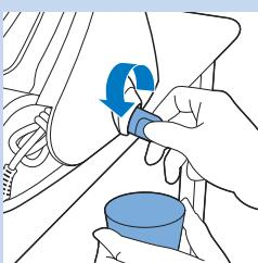
**5** Tenete una tazza sotto la manopola EASY DE-CALC e ruotate la manopola in senso antiorario.
