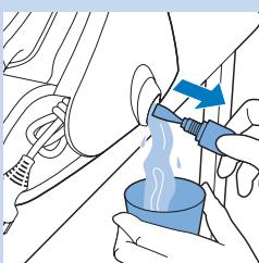
**6** Rimuovete la manopola EASY DE-CALC e lasciate fluire l'acqua con le particelle di calcare nella tazza.
