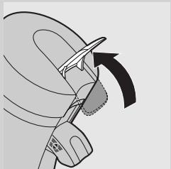
**3 Skjut spaken uppåt för att öppna locket.**
