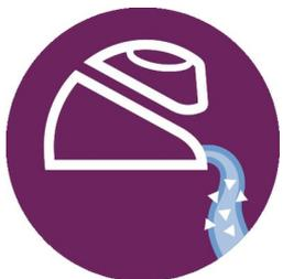
Регулярная очистка от накипи защищает утюг, продлевает срок его службы и обеспечивает эффективную подачу пара. Уникальная система Easy De-Calc Plus постоянно собирает накипь, а звуковой и световой индикаторы сообщают, когда необходимо опустошить контейнер. Просто снимите клапан и вылейте грязную воду с частицами известкового налета.
