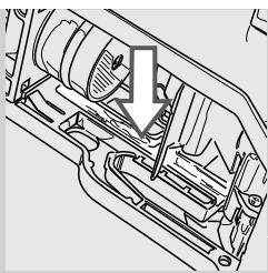
**1** Jednolikom nanesite mast na obje bočne vodilice.
