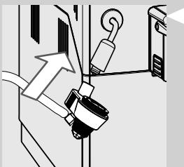
**5** Provjerite je li pravilno postavljen. Zakrenite kromiranu oblogu ako ga ne uspijete umetnuti. Element za automatsko tučenje mlijeka postavljen je pravilno kada zubac ulegne u žlijeb.
