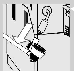
**1** Uklonite element za automatsko tučenje mlijeka s cijevi za paru.
