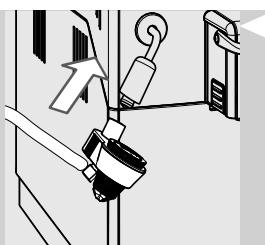
**27** Postavite element za automatsko tučenje mlijeka na gumenu zaštitu.
