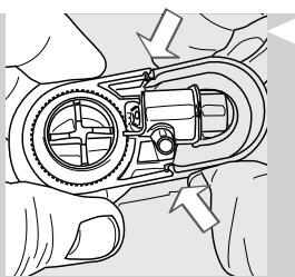
**23** Postavite element za automatsko tučenje mlijeka na priključak i provjerite je li dobro pričvršćen u označenim ležištima.
