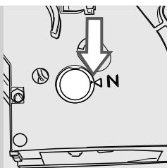
**10** Provjerite je li sklop za ispuštanje u neutralnom položaju: dvije bočne oznake na sklopu za ispuštanje moraju se podudarati. U protivnom, slijedite upute koje su opisane pod točkom 11.
