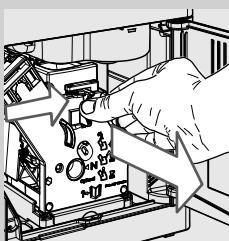
**19** Provjerite je li pravilno postavljen. Zakrenite kromiranu oblogu ako ga ne uspijete umetnuti. Element za automatsko tučenje mlijeka postavljen je pravilno kada zubac ulegne u žlijeb.
