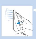
Μπορείτε επίσης να χρησιμοποιήσετε τη λειτουργία βολής ατμού ενώ κρατάτε το σίδερο σε κάθετη θέση.
