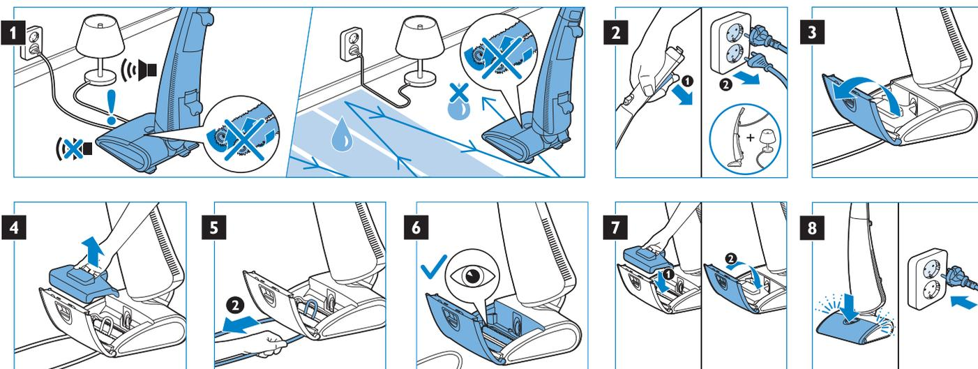
**Filling the clean water tank, Таза су ыдысын толтыру, Švaraus vandens bako pildymas, Tīrā ūdens tvertnes piepildīšana, Temiz su haznesinin doldurulması, Наповнення резервуара для чистої води**
