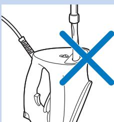
Nelijte do žehličky otvorem funkce Quick Calc Release vodu, ocet a odvápňovací přípravky.
