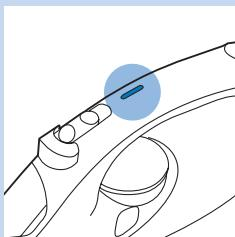
Funkcja automatycznego wyłączania samoczynnie wyłącza żelazko, jeśli nie było ono używane przez 30 sekund po umieszczeniu na stopie lub przez 8 minut po umieszczeniu na płyce tylnej. Wskaźnik automatycznego wyłączania zacznie świecić.
