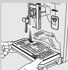
**4** Introduza a bandeja de limpeza (exterior) com grelha na máquina. Verificar que esteja correctamente inserida.
