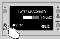
**6** Depois de terminada a distribuição da espuma de leite, a máquina começa a distribuir o café. Quando alcançar a quantidade de café desejada, pressione a tecla "ESC".
