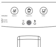
Dacă butonul CALC CLEAN (detartrare) luminează continuu, trebuie să detartrați aparatul. Dacă nu detartrați aparatul atunci când butonul indică acest lucru, aparatul va înceta să mai funcționeze corect. În acest caz, reparațiile nu sunt acoperite de garanție.
