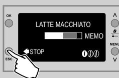
**5** Kada se prikazuje ovaj ekran, aparat pokreće ispuštanje mlečne pene u šolju. Pritisnite taster "ESC" čim se postigne željena količina kafe.
