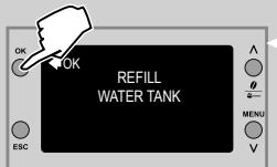
**12** Po okončanju ispuštanja napunite rezervoar svežom vodom sve do nivoa MAX. Pritisnite taster "OK" za potvrđivanje.
