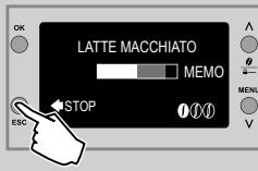
**6** Po okončanju ispuštanja mlečne pene aparat pokreće ispuštanje kafe. Kada se postigne željena količina kafe, pritisnite taster "ESC".
