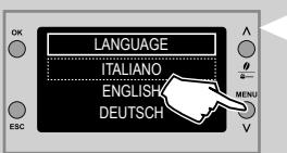
**13** Pojavljuje se sledeći prikaz na ekranu. Odaberite željeni jezik pritiskom na tastere za prelistavanje "V" ili "A".
