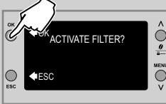
**11** Pritisnite taster "OK" da biste potvrdili da želite da pokrenete proceduru aktiviranja filtera.
