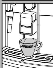
Za podešavanje, podižite ili spuštajte ručno blok za ispuštanje kafe stavljajući prst kao što je prikazano na slici.
