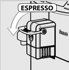
**6** Comprobar que la palanca esté posicionada en "ESPRESSO".
