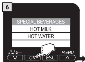
Pasirinkite "HOT WATER" (karštas vanduo), spausdami mygtukus  $\wedge$  ir  $\vee$ . Spauskite OK mygtuką ir laukite, kol bus paruoštas užprogramuotas kiekis.
