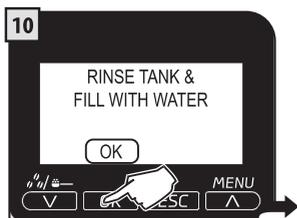
Išskalaukite vandens talpyklą ir pripildykite ją gėlu geriamu vandeniu iki "MAX" žymos. Tuomet spauskite "OK" mygtuką.
