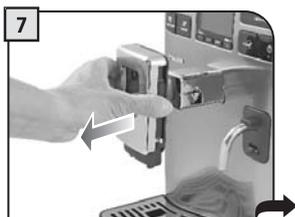
7 Išimkite išpylimo kranelį ir išplaukite jį vandeniu.
