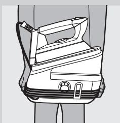
**4** Utilice las asas situadas a ambos lados del generador de vapor para mover el aparato.
