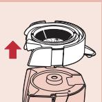
**3** Tháo ngăn hứng nước ép cùng với bộ lọc ra và sau đó tháo vòi nước ép ra khỏi ngăn hứng nước ép.
