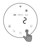
**自動模式(④)**:在自動模式中,雙重感應器會即時感測空氣質素,本產品會根據空氣質素環境自動調整風扇速度。控制面板會根據環境光線自動調整螢幕亮度。
