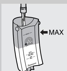
**2** Riempite il serbatoio con acqua fredda fino all'indicazione MAX e rimettetelo sulla macchina.
