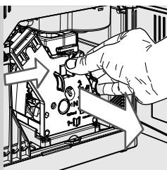
**26** Nakon završetka izvođenja postupka uklanjanja kamenca, operite sklop za ispuštanje kako je opisano u poglavlju "Postupak tjednog čišćenja sklopa za ispuštanje".
