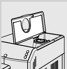
Jednom mjesечно navlaženom krpom očistite prazni spremnik kave u zrnu kako biste uklonili uljaste tvari iz kave. Ponovno napunite spremnik kavom u zrnu.
