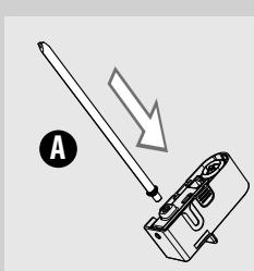
**14** Umetnite cijev usisa opremljenu priključkom (A) u element za tučenje mlijeka.
