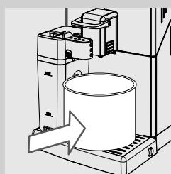
**16** Umetnute vrč za mlijeko u aparat. Izvucite ispust vrča udesno sve do simbola "▲". Stavite posudu ispod ispusta kako biste pokrenuli izvođenje postupka ispiranja.
