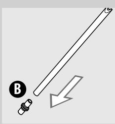
**13** Postavite priključak (B) na cijev usisa.
