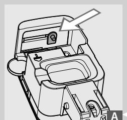
**16** Ako ispust ne možete postaviti na gornji dio vrča, osovina je postavljena u pogrešan položaj (B). Prije postavljanja ispusta, rukom gurnite osovinu u položaj (A).
