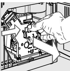
**11** Uklonite i ispraznite kadicu za sakupljanje kapi i ladicu za sakupljanje taloga te otvorite servisna vratašca. Izvucite sklop za ispuštanje.
