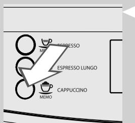
**5** Ispuštanje kave se prekida automatski kad se postigne podešena razina dok se postupak ispuštanja može prekinuti i pritiskom tipke " MEMO".
