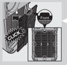
4 將預過濾網裝回產品中。將所有扣鉤正確扣入產品。
