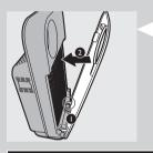
**5** 若要重新裝入正面護板,先將底部扣鉤裝入產品底部 (1)。 然後將護板推入產品機體 (2)。
