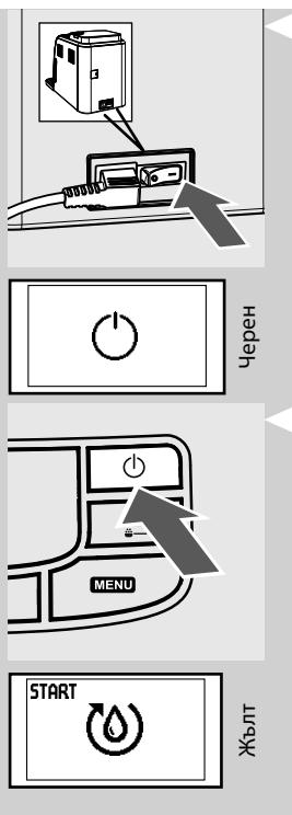
**12** Придвигнете главния бутон за включване/изключване до положение „I“, за да включите машината. Дисплеят изобразява иконата за режим „stand-by“.
