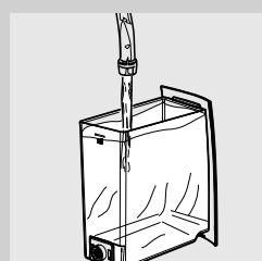
**2** Резервоарът трябва да се напълни с прясна вода до ниво „MAX“.
