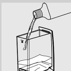
**6** Извадете резервоара за вода и изсипете в него цялото съдържание на препарата за отстраняване на котлен камък на Saeco. Напълнете резервоара с прясна вода до ниво MAX.
